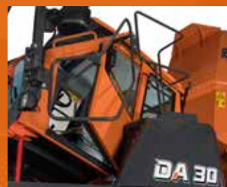
Bezpečnostní zábradlí kolem celé kabiny
