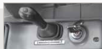
Funkce plovoucího dozeru a přepínač režimu pojezdu
