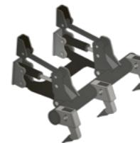
Dozer Develon je vybaven potrubím pro snadnou montáž volitelného paralelního žramenného rozrývače. Rozrývač je vybaven paralelním závěsem, který pomáhá udržovat konstantní úhel vůči terénu bez ohledu na výšku. Toto příslušenství pomáhá rychle rozbít tvrdé, odolné materiály před srovnáváním.
